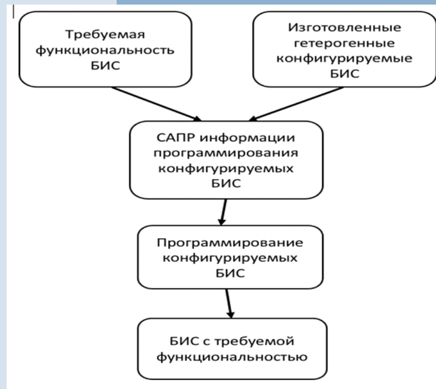
Алгоритм программирования БИС с требуемой функциональностью
