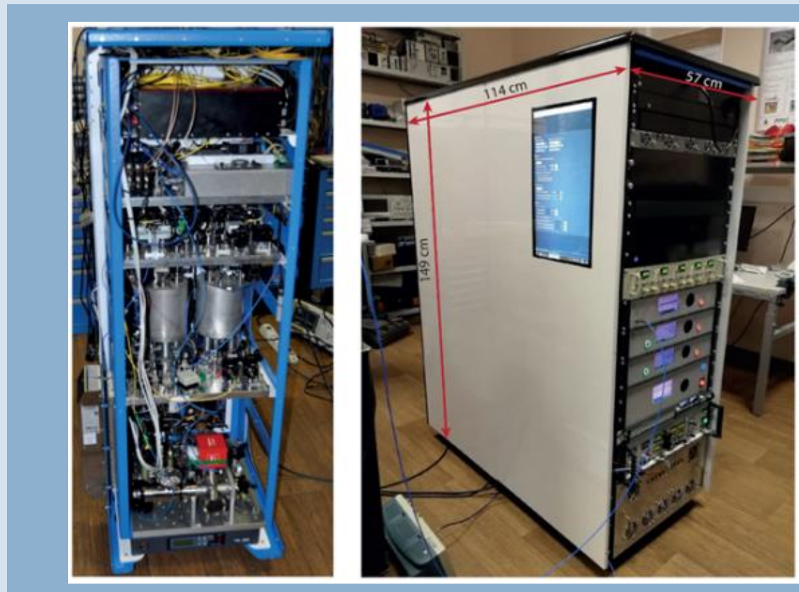
Транспортируемые оптические часы на одиночном ионе иттербия
