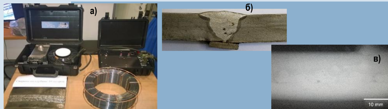
Портативный сварочный комплекс, порошковые проволоки (а), опытное сварное соединение (б), макроструктура и рентгеновский контроль шва толщиной 21,3 мм из бейнитной стали API X70 (в)
